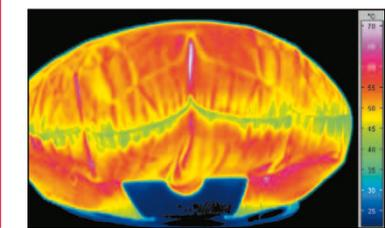
Funktionsprüfung einer Lenkradheizung
