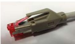
Abb. 10 RJ45-Stecker des Ethernet-Kabels
