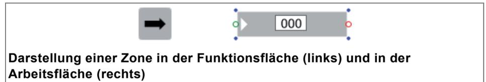
Der Pfeil zeigt die Förderrichtung an. Die roten und grünen Kreise sind Fangpunkte, mit denen mehrere Zonen verbunden werden können. Die blauen Punkte zeigen die Eckpunkte an. Die Fangpunkte und Eckpunkte können ausgeblendet werden (*siehe "Menüleiste", Seite 24*). Die Zahl ist die Zonenbezeichnung (es werden immer die letzten drei Stellen der Zonenbezeichnung angezeigt).
