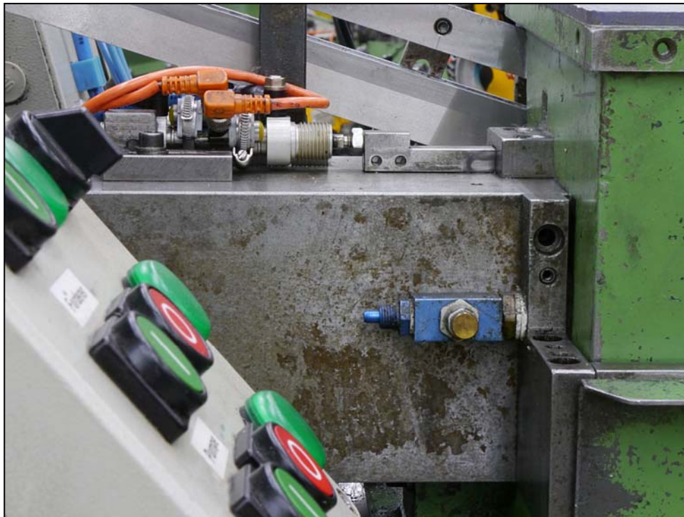
Abb. 6: Zwei äußerst kompakte Sensoren auf einem extrem kurzen Pneumatikzylinder.
