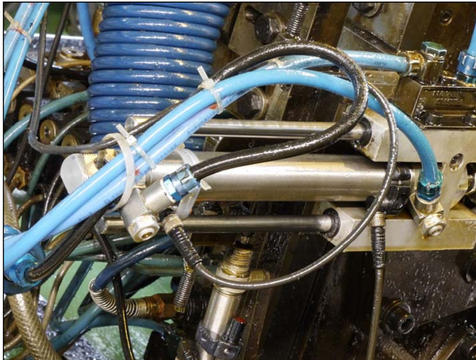
Abb. 8: Zylinder-Sensoren in extrem ölhaltiger Umgebung an einer Maschine.
