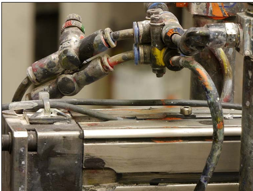
Abb. 7: Die Sensoren widerstehen selbst Farbspritzern, eingetrockneten Farbbresten oder Reinigungs- sowie Lösungsmitteln.
