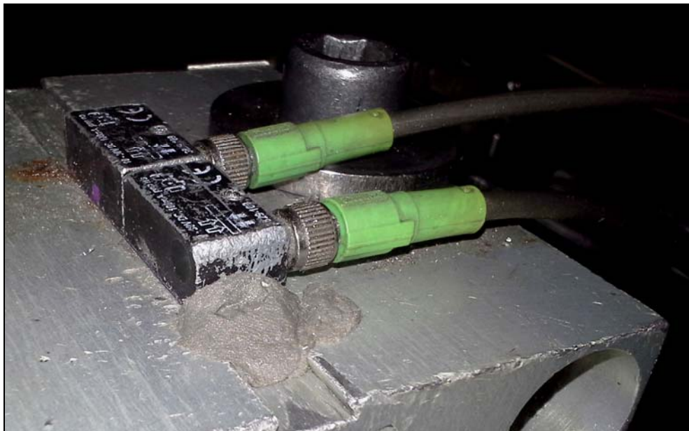
Abb. 5: Magnetische Zylinder-Sensoren an einem speziellen Hydraulikzylinder. Die Sensoren müssen sehr hohen mechanischen Belastungen und Temperaturen bis +100°C standhalten.
