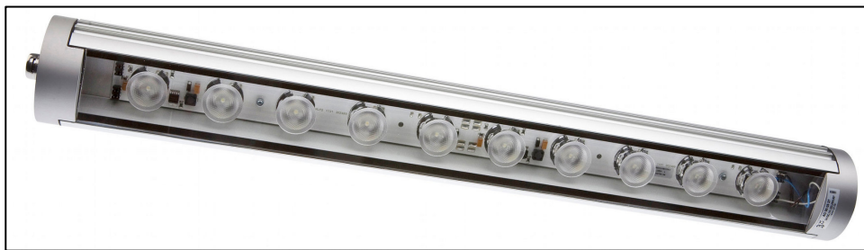
Abb. 8: Das Aluminium-Strangpressprofil lässt sich wahlweise mit fünf, zehn oder 20 LED bestücken und verfügt über eine gute Wärmeableitung.
