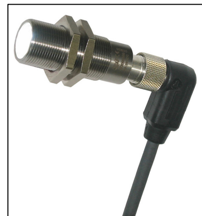
Abb. 2: Robuste M18-LED-Leuchten sind aufgrund ihrer Abstrahlwinkel von 22° (mit drei LED) sowie 120° (mit einer LED) sehr vielseitig einsetzbar und können direkt in eine Maschine oder einen Schaltschrank montiert werden.
