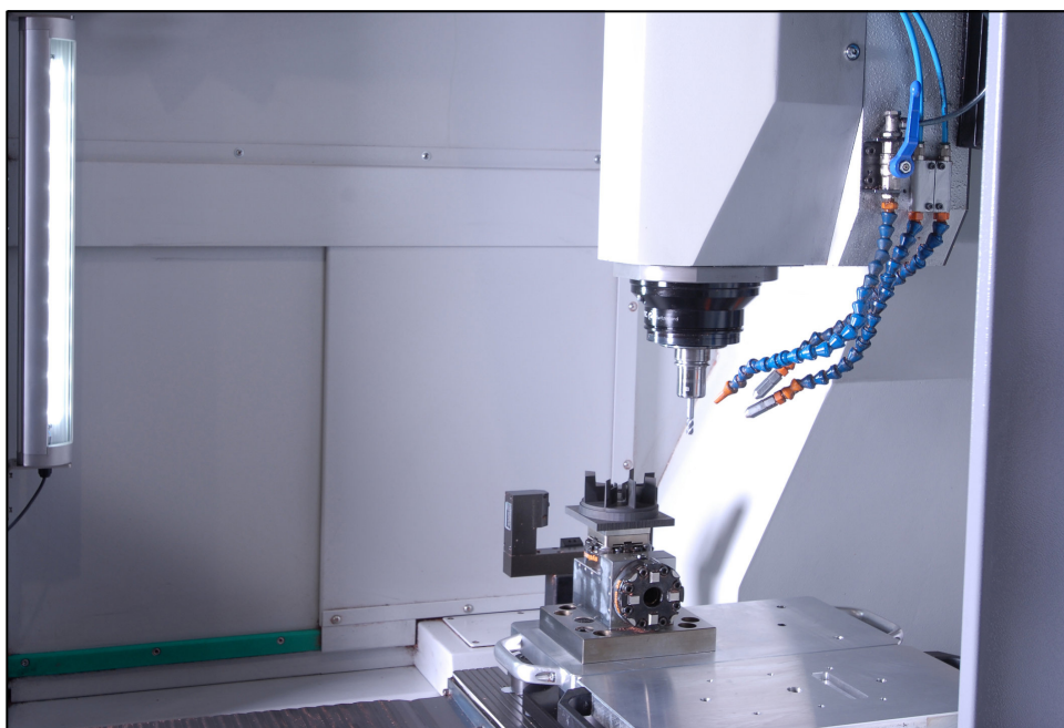
Abb. 8.1: Da alle Dichtungen der High-Power-Leuchte aus Viton bestehen, verfügt sie über die Schutzart IP67.
