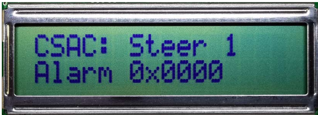
Figure 2.7 CSAC steering display page
