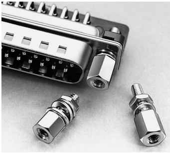
コネクタ両端に装着し、相手コネクタ（ケーブル側）に付属したジャンクションシェルの嵌合固定用雄ネジと結合させる固定台です。1個のコネクタに対し、固定台は2個必要です。ご発注の際は、ネジの種類を確認のうえ、ご指示ください。
