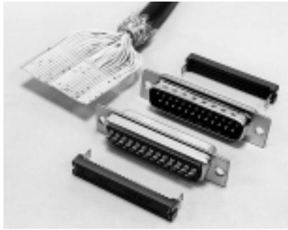
フラットリボンケーブルの被覆除去作業が不要で、全芯数を同時に一括結線できるセルフピアシング方式の圧接型コネクタです。
