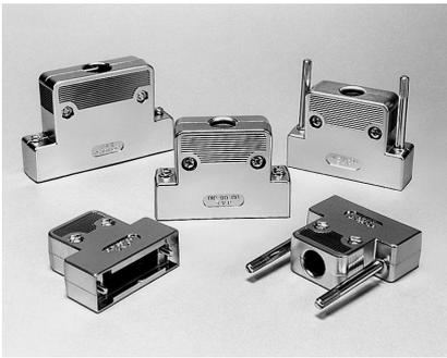
組立容易なツープース構造(分割型)で、合わせ溝に独特の段差を設け、コネクタフランジを確実に覆いシールド効果を高めた軽量フードです。
