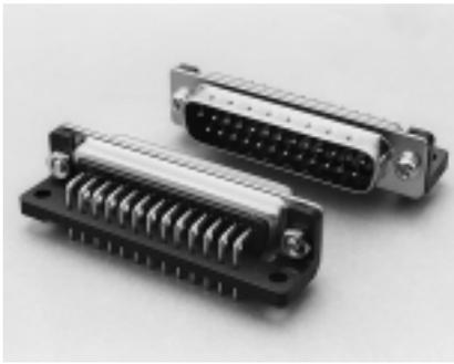
基板スルーホール接続用のアングルタイプD※-※※A-N（プレスコンタクト、インシュレータUL規格材、ローコスト型）と同形状のEMI対策型です。ピン側フロントシェルにグラウンディングディンプル加工付きで、相手シェルとの接触を確実にします。
