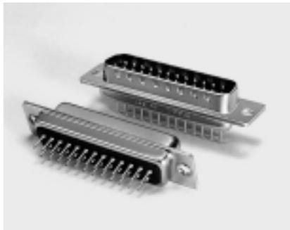
基板スルーホール接続用のストレートタイプD※-※※T-N（プレスコンタクト、汎用型）と同形状のEMI対策品です。但し、ピン側フロントシェルはグラウンディングディンプル加工付きで、仕上はニッケルメッキになっております。
