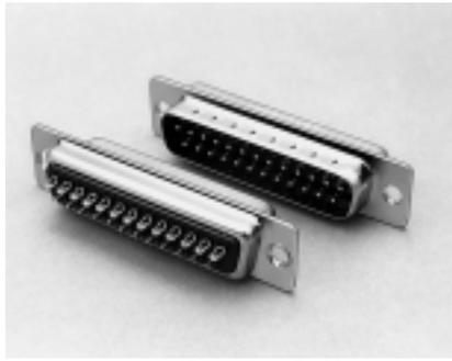
半田結線式の標準タイプD※-N（プレスコンタクト使用）と同形状で、シェルはニッケルメッキ仕上、ピン側フロントシェルにグラウンディングディンプル加工がしてあり、シェル同士の接触を確実にし、シールド効果を高めたEMI対策型です。
