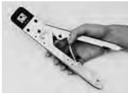
コンタクトを挿入する前に、ハンドルを開放状態にします。ハンドルを一杯まで締め付けてから離すと、自動的に開放されます。
