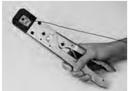
電線がセットの位置からずれないように注意しながら、ハンドルを徐々に握り締め、ラチェットが外れるまで締め付けます。この状態で圧着結線は完了です。
