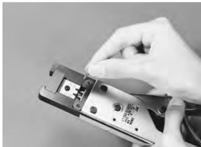
圧着するコンタクトを、接触部を先にしてロケータ内に挿入し、コンタクト先端がコンタクトストッパーに突き当たるまで挿入します。この時、コンタクトのバレルの開口部が上を向くように、コンタクトの倒れは修正して下さい。
