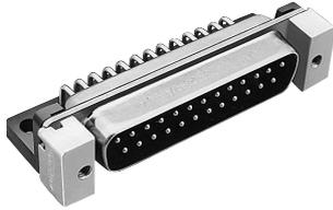
プリント基板上に、直接半田付接続するD※型J4タイプ(アングルスルーホール、マシンコンタクト使用)に、相手側との嵌合固定台をフランジ両サイドに付属させた製品です。この嵌合固定台は、相手コネクタにつけたプラスチック製分割型ジャンクションシェル(D※-C1、D※-C8型等)の接続ネジを受けてコネクタ同士を固定できるネジ穴付台です。
