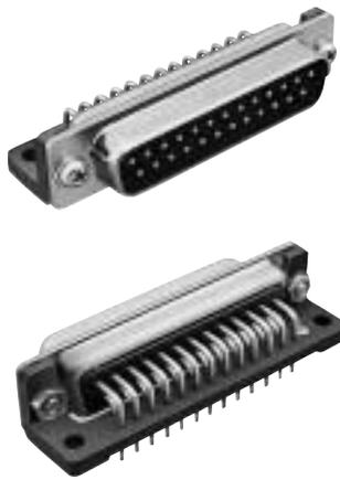
コンタクト端末部は90°アングルタイプで、基板に平行して回路を取り出せます。基板への取付は、基板回路上的のスルーホールにコンタクトを挿入後、取付ブラケットをネジ止め固定し、半田付にて接続します。
