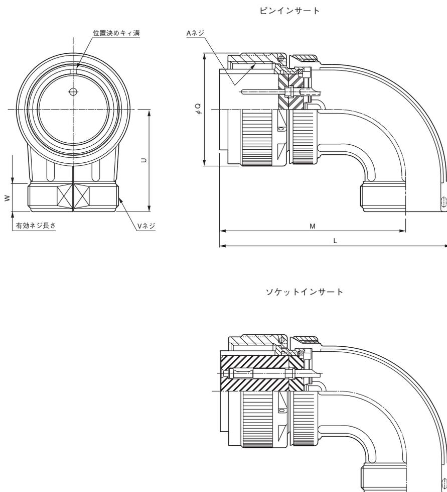
(注1)シェルサイズ10SL(ソケットインサート)は、上図と形状が異なり、金属の外殻(パレル)がインシュレータの先端(嵌合側)まで覆っていない構造です。詳細については、別途お問い合わせ下さい。
