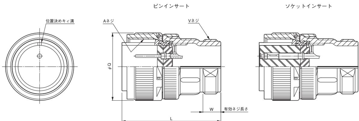
(注1) シェルサイズ10SL(ソケットインサート)は、上図と形状が異なり、金属の外殻(バレル)がインシュレータの先端(嵌合側)まで覆っていない構造です。詳細については、別途お問い合わせ下さい。
