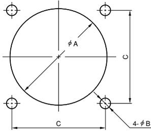
(注1)  $\phi A$ は、フロント側及びリア側からの取付けに共通の寸法です。
