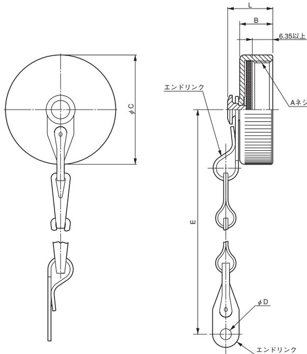
(注) 中継用レセプタクル・N/MS3101Bにケーブルクランプ(N/MS3057)を取付けて使用する場合、シェルサイズ22以下では、チェーン末端をケーブルクランプに取付ける事はできません。
