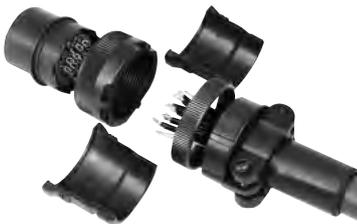
分解した各部分(カップリングナット、アッセンブリナット)及びケーブルクランプを半田付前に予めケーブルに通してから結線を行って下さい。エンドバルは、結線後にアッセンブリナットで取付けます。
