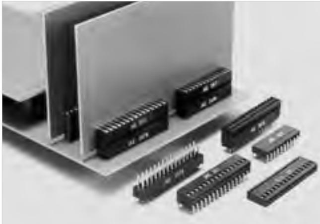
オリジナルピンヘッダとソケットレセプタクルの組合せで、基板対基板の垂直又は平行接続が出来ます。1列タイプと2列タイプが有ります。ソケットレセプタクルは、ディップタイプハウジング内に予めソケットコンタクトが組込まれていて、基板上的のスルーホールに半田付けにて固定します。
