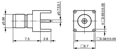
基板取付穴寸法 (参考・装着面)
