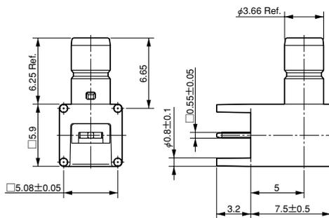
基板取付穴寸法 (参考・装着面)
