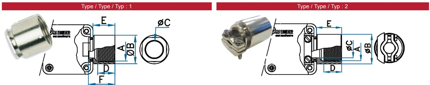
L'embout à filetage est maintenu entre les deux coquilles de la fiche, du prolongateur ou du boîtier pour embase. Ces embouts sont en laiton protégés par nickelage.
