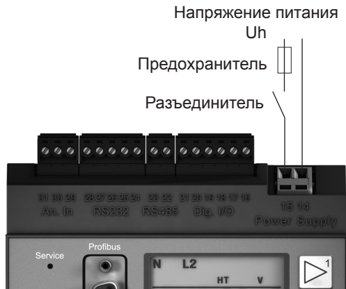
Рис. 23.1. Пример подключения для напряжения питания U_n .
