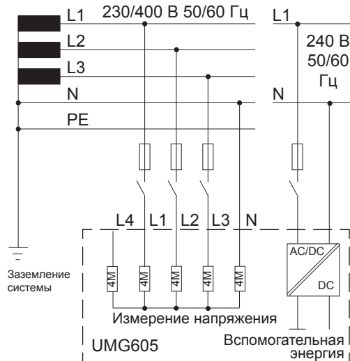
Рис. Принципиальная схема, UMG605 в TN-сети.
