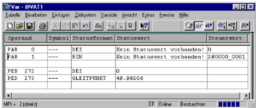
**Beispiel: Digital-Ausgang 1 und Digital-Ausgang 2 über Profibus setzen.**
