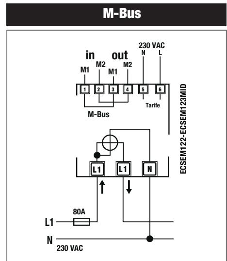
Für den Leitungsschutz wird eine Sicherung von 80 A empfohlen.
