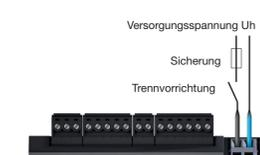
Abb. Anschlussbeispiel für die Versorgungsspannung Uh.
