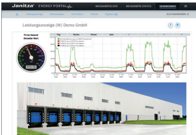
Beispiel eines Dashboards mit Liniendiagramm (Lastprofil) und Anzeige des aktuellen Leistungswertes mittels analoger Zeigeranzeige.
