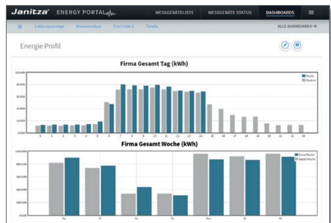
Dashboard-Beispiel mit zwei Balkendiagrammen zum Vergleich von Arbeitswerten des aktuellen Tages mit dem Vortag oder der aktuellen Woche mit der Vorwoche.
