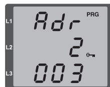
Fig. TCP / IP address, byte 2, value 003
