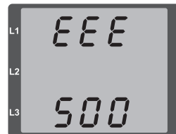
Abb. Warnmeldung mit Nummer 500 (Netzfrequenz)
