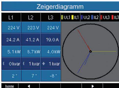
Im Zeigerdiagramm werden die Spannungen mit langen Zeigern und die Ströme mit kürzeren Zeigern dargestellt.
