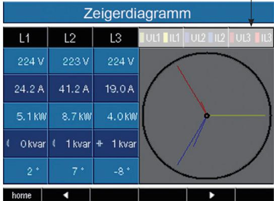
Darstellung der Phasenreihenfolge entsprechend der Drehfeldrichtung.
