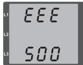
Рис. Предупреждение с номером 500 (частота сети)
