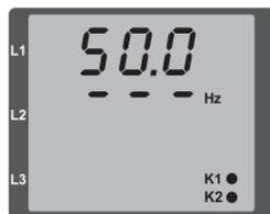
*Рис. Установить направление вращающегося поля невозможно.*
