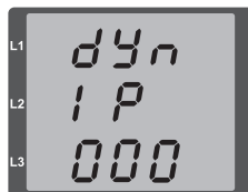
Paramétrage de l'allocation d'une adresse TCP/IP fixe
