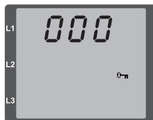
Fig. Demande de mot de passe Si le mot de passe a été défini, les touches 1 et 2 permettent de le saisir.
