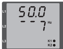
Afb. weergave van de netfrequentie (50.0) en de draaiveldrichting
