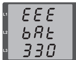
Afb. klok-/batterijfout met nummer 330 (de klok staat stil en moet ingesteld worden).
