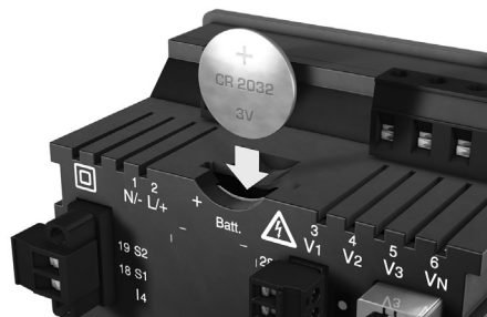
Afb. de batterij kan er aan de achterkant ingestoken worden
