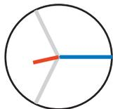
Tension et intensité ont un écart d'environ 180° dans la position de phase.
