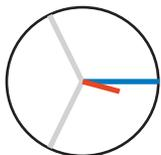
Tension et intensité n'ont qu'un faible écart dans la position de phase.
