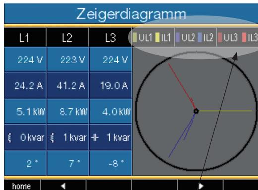
Représentation de la séquence de phases en fonction de la direction du champ magnétique rotatif.
