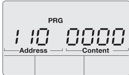
*Abb. Anzeigenbeispiel; Mess-Schaltung für die Hauptmessung, Adresse 110 mit dem Inhalt 0.*
