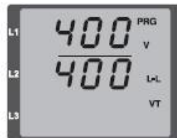
図：電圧トランス設定モード 1次電圧と2次電圧をボタン1とボタン2を使って、変更できます。(参照p41)
