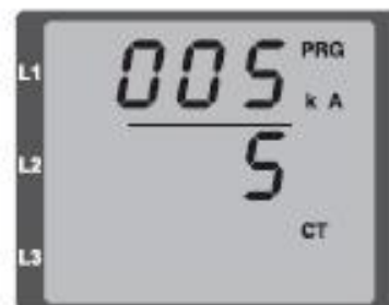
図：電流トランス設定モード 1次電流と2次電流をボタン1とボタン2を使って、変更できます。(参照p40)
