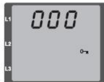
図：パスワードリクエスト パスワードが設定されていたらボタン1とボタン2を使って、入力します。
