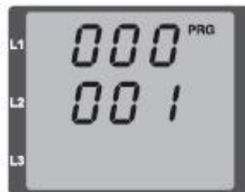
図：パラメータ設定モード 個々のパラメータをボタン1とボタン2を使って、変更できます。(参照p36)
