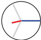
Tension et intensité ont un écart d'environ  $180^\circ$  dans la position de phase.
