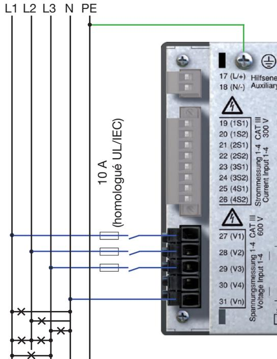
Fig. Exemple de raccordement pour la mesure de la tension.
