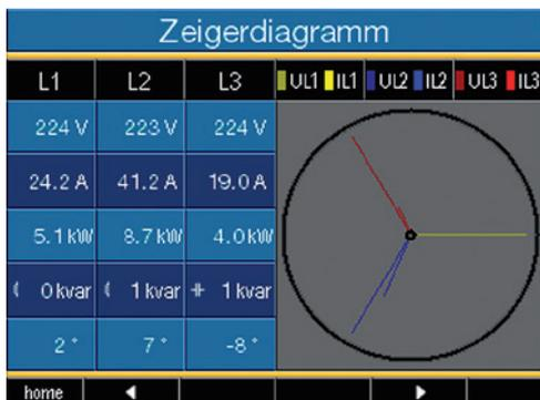
Dans le diagramme vectoriel, les tensions sont représentées par des aiguilles longues, et les intensités par des aiguilles plus courtes.
