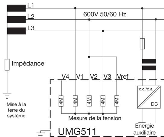
Fig. Schéma de principe, UMG511 dans réseau IT sans N.
