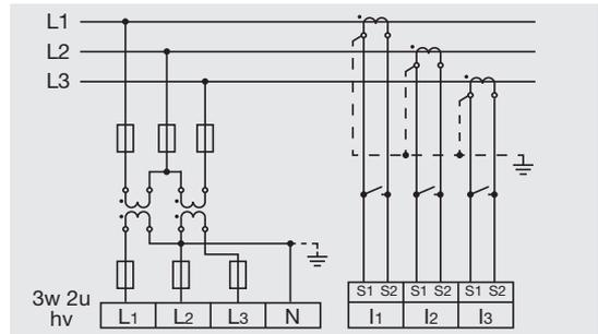
Fig. Mesure sur un réseau triphasé à 3 conducteurs à charge dissymétrique.
