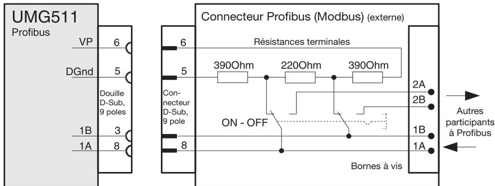
Fig. Connecteur de Profibus avec résistances de terminaison.
