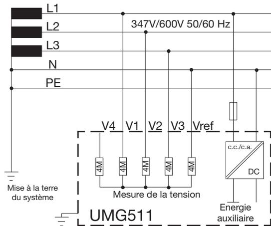
Fig. Schéma de principe, UMG511 dans le réseau TN.
