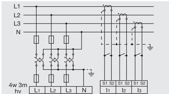
Fig. Mesure par 3 transformateurs de tension sur un réseau triphasé à 4 conducteurs à charge dissymétrique.
