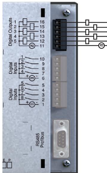
*Fig. Raccordement de sorties numériques.*
