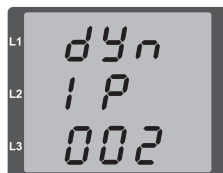
Abb. Parameter-Einstellung zur dynamische Vergabe (DHCP) einer TCP/IP- Adresse
