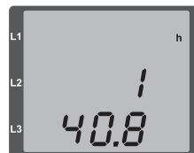
Abb. Messwertanzeige Betriebsstundenzähler
