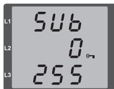
Abb. Subnetzmaske (Sub), Byte 0, Wert 255
