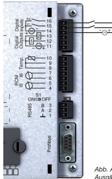
Abb. Beispiel für den Anschluss der externen Schaltkontakte S1 und S2 an die digitalen Eingänge 1 und 2.
