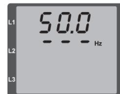
Abb. Keine Drehfeldrichtung feststellbar.
