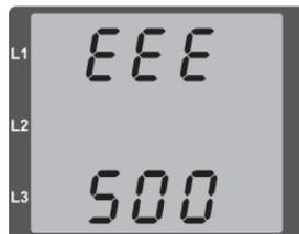
Abb. Warnmeldung mit Nummer 500 (Netzfrequenz)
