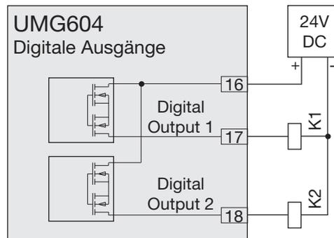
Abb.39.2 Anschluss von Gleichstrom-Relais an die digitalen Ausgänge.
