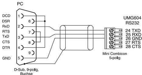
Abb. Steckerbelegung für das PC-Verbindungskabel (Art.Nr. 08 02 427).
