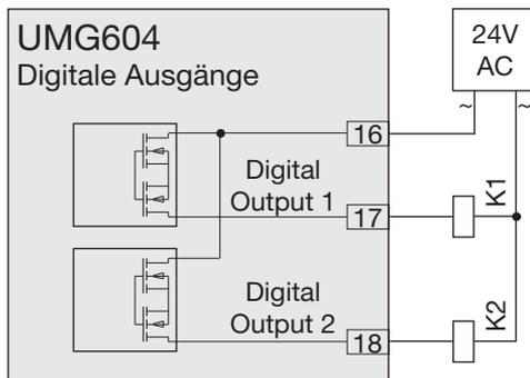
Abb.39.1 Anschluss von Wechselspannungs-Relais an die digitalen Ausgänge.
