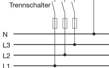
Abb. Anschlussbeispiel: Spannungsmessung über kurzschlussfeste Messleitungen.
