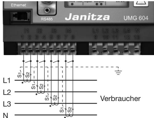
Abb. Anschlussbeispiel, Strommessung über Stromwandler.
