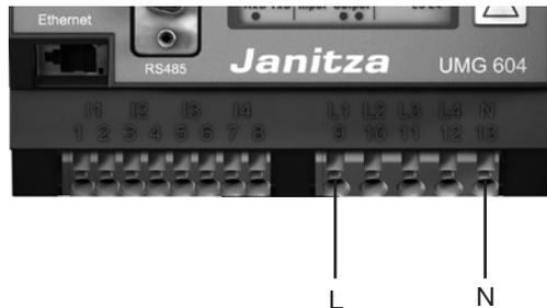
Für die Messung muss am Spannungsmesseingang mindestens eine Phase (L) und der Neutralleiter (N) angeschlossen werden.
