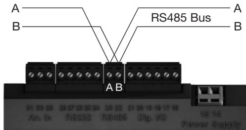
Abb. RS485-Schnittstelle, 2-poliger Steckkontakt
