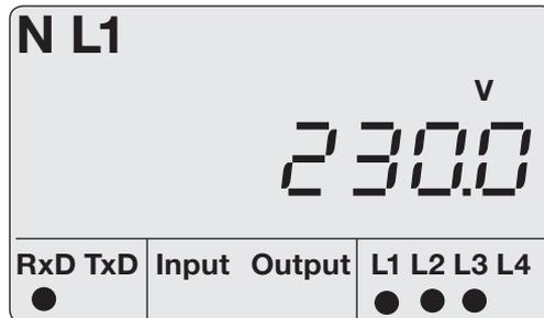
Abb. 19.1 Anzeigenbeispiel „Anzeige-Modus“. Angezeigter Messwert:  $U_{L1-N} = 230,0V$ .
