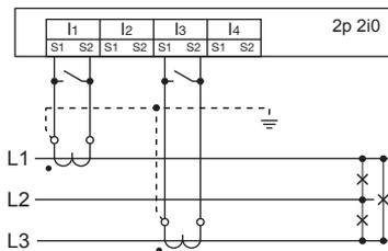
Abb. Strommessung, Anschlussbeispiel für die Anschlussvariante 1 (Siehe Seite 50).
