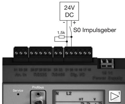
Abb.41.1 UMG604 mit Eingängen für 24V. Beispiel mit S0 Impulsgeber.
