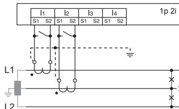
Abb. Strommessung im Einphasen-3-Leiter-system. Anschlussvariante 0 (Siehe Seite 50).
