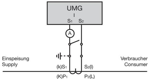
Abb. Beispiel, Strommessung über zusätzliches Amperemeter.
