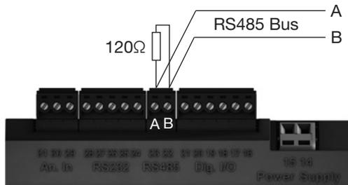
Abb. RS485-Schnittstelle, 2-poliger Steckkontakt mit Abschlusswiderstand (Art.-Nr. 52.00.008).
