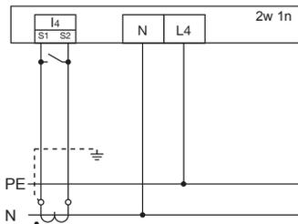
Abb. Messung der Spannung zwischen N und PE. Messung des Stromes im Neutralleiter.
