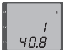
Abb. Messwertanzeige Betriebsstundenzähler
