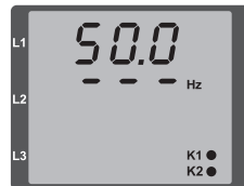
Abb. Keine Drehfeldrichtung feststellbar.
