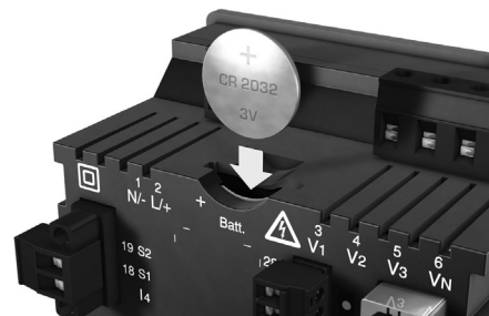
Abb. Batterieeinschub auf der Rückseite
