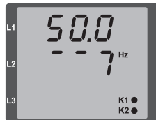
Abb. Anzeige der Netzfrequenz (50.0) und der Drehfeldrichtung
