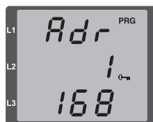
Fig. Adresse TCP/IP, octet 1 Une adresse TCP/IP est composée de 4 octets avec la structure suivante :
