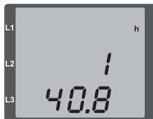
Abb. Messwertanzeige Betriebsstundenzähler
