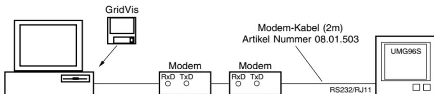
Abb. UMG96S über Modem mit einem PC Verbinden.
