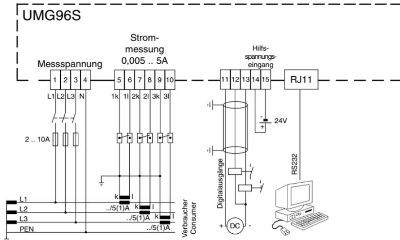
Abb. UMG96S mit RS232 und Digitalausgängen.
