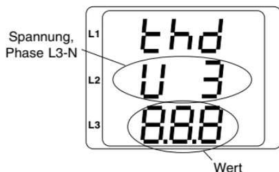
In diesem Beispiel wird der Klirrfaktor **THD** der Spannung aus der Phase L3 angezeigt.
