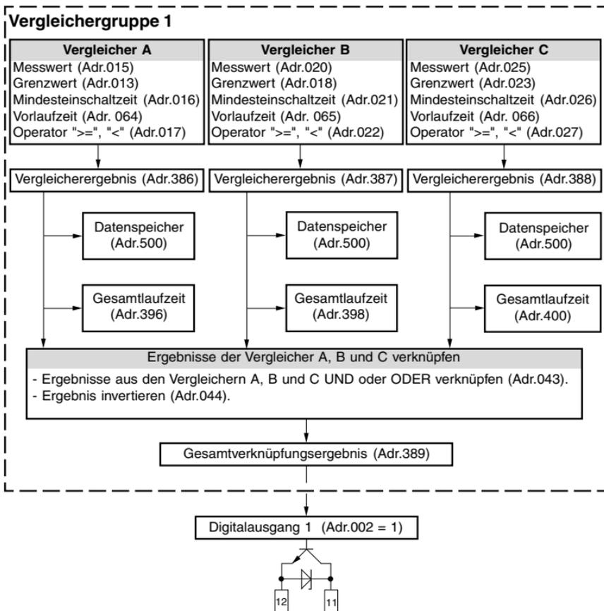
Abb. Grenzwertüberwachung mit Digitalausgang 1.
