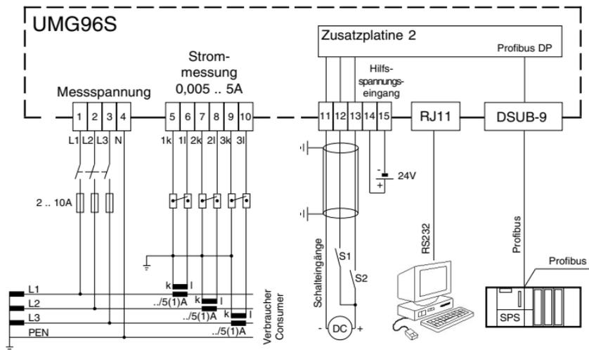
Abb. UMG96S mit Schalteingängen, RS232 und Profibus.
