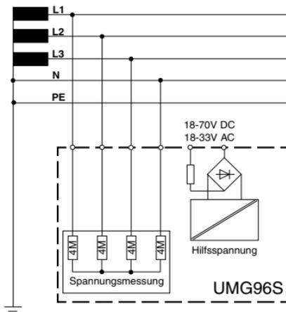
Abb. Blochschaubild Betriebsspannungsgewinnung und Messspannung.
