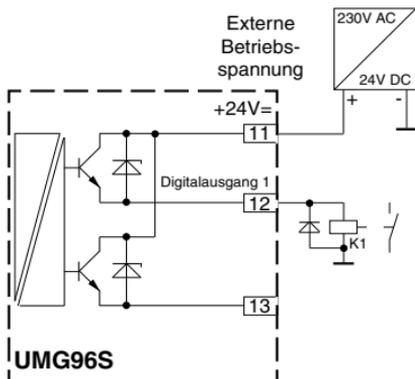
Abb.: Anschlussbeispiel für Digitalausgang 1.
