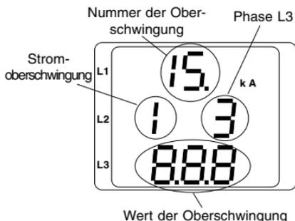
In diesem Beispiel wird 15. Oberschwingung des Stromes in Phase L3 angezeigt.
