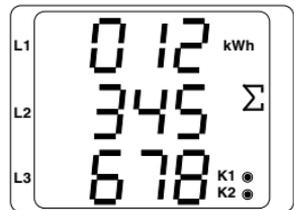
Die in diesem Beispiel angezeigte Wirkarbeit beträgt: 12 345 678 kWh
