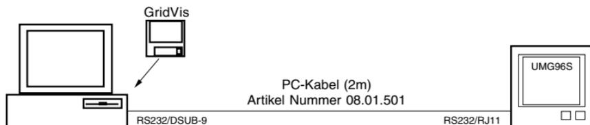
Abb. Das UMG96S mit einem PC über ein PC-Kabel verbinden.
