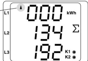
Die in diesem Beispiel angezeigte Wirkarbeit beträgt: 134 192 kWh
