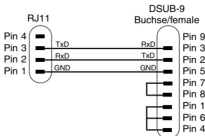
Abb. Modem-Kabel, Art. Nr. 08.01.503 (2m)
