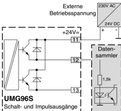
Abb.: Anschlussbeispiel für die Beschaltung der Klemmen 11 bis 13 als Impulsausgang.
