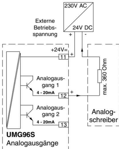
Abb. Anschluss eines Analogausganges an einen Analogschreiber.
