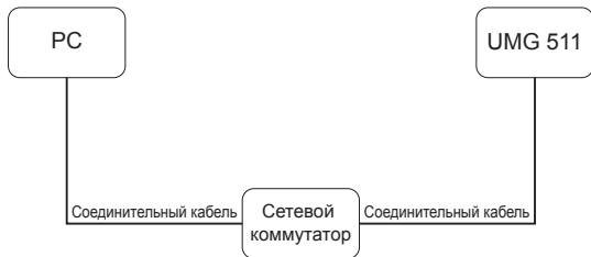
Рис. Пример подключения, для UMG511 и ПК требуется фиксированный IP-адрес.
