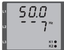
Fig. Affichage de la fréquence du réseau (50,0) et de la direction du champ rotatif
