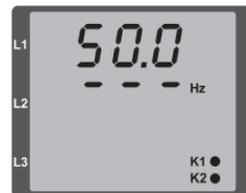
Fig. Aucune direction du champ rotatif ne peut être déterminée.
