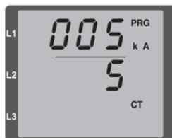
Fig. Mode de programmation du convertisseur d'intensité
