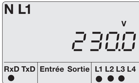
Fig. Exemple d'affichage "mode d'affichage". Valeur mesurée affichée : U_{L1-N} = 230,0 \text{ V} .
