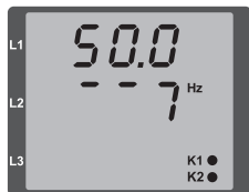
Abb. Anzeige der Netzfrequenz (50.0) und der Drehfeldrichtung
