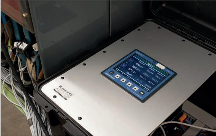
**Bild 4:** Wie die Messwertspeicherung zeigt, ist der überwachte Abgang gut ausgelastet. Der Nennstrom beträgt 1000A, die Phase L2 wurde zeitweise mit 933 A belastet.
