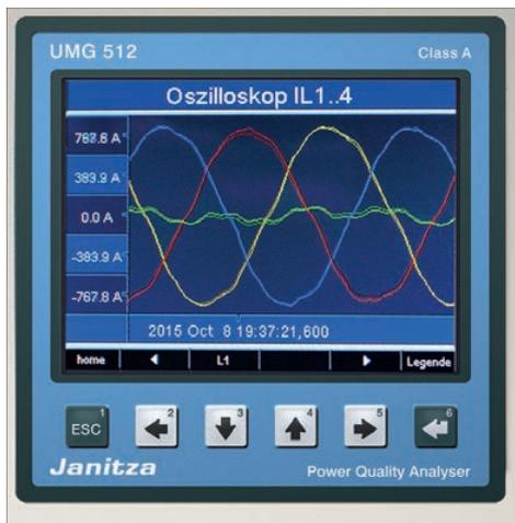
Bild 11: Nichtlineare Lasten führen zu Harmonischen und Rückspeisungen. Die Messung zeigt, wie sich diese auf dem Neutralleiter (Grün) addieren.
