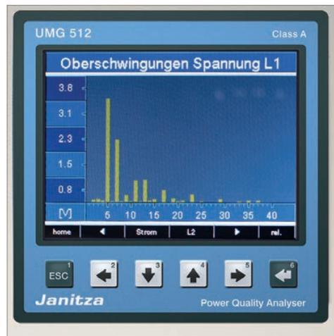
Bild 12: Das UMG 512 kann Harmonische detailliert erfassen und darstellen: hier die 5, 7, 11 und 13 Oberschwingung.
