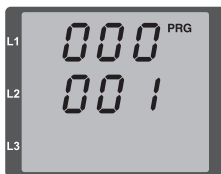
Abb. Programmier-Modus Parameteranzeige Über die Tasten 1 und 2 können die einzelnen Parameter geändert werden (vgl. Seite 48).
