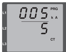
Abb. Programmier-Modus Stromwandler Über die Tasten 1 und 2 können Primär- und Sekundärstrom geändert werden (vgl. Seite 52).
