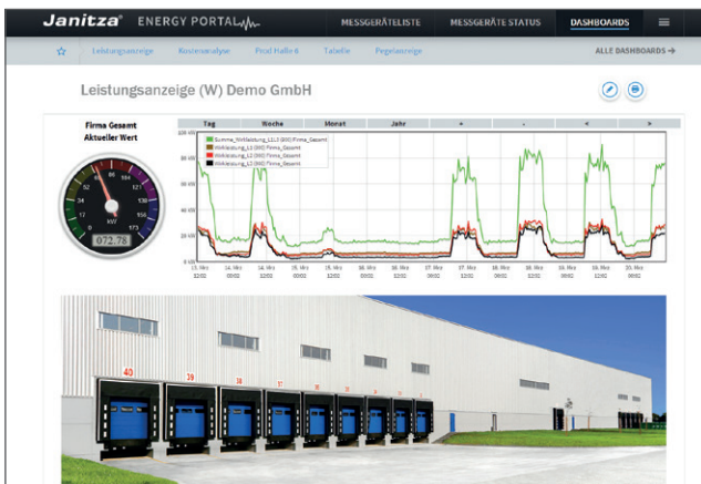
Exemple d'un dashboard avec un graphique (courbe de charge) et la puissance affichée via un indicateur analogique.
