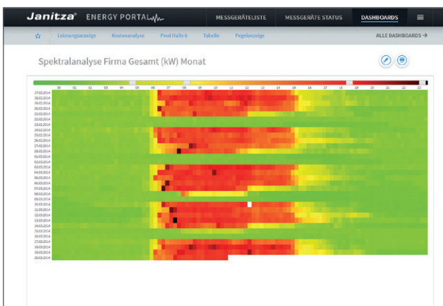
Carte thermique (analyse de spectre) pour déterminer les pics de charge qui augmentent les coûts. La barre de défilement en haut de cette carte peut être utilisée pour ajuster chaque valeur seuil.
