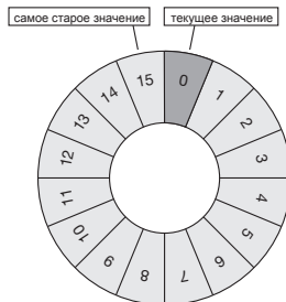
Рис.: Кольцевой буфер на 16 ячеек поля
