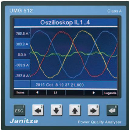
**Bild 3:** Nichtlineare Lasten führen zu Harmonischen und Rückspeisungen. Die addieren sich auf dem Neutralleiter (Grün)
