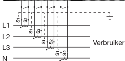
Afb. aansluitvoorbeeld, stroommeting via stroomtransformatoren.
