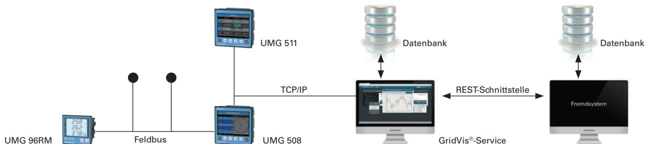
Datentransfer zwischen GridVis®-Service und einem Fremdsystem über REST-Schnittstelle
