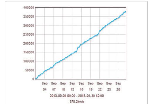
Graphische Darstellung der Energiewerte über REST-Schnittstelle aus der GridVis®
