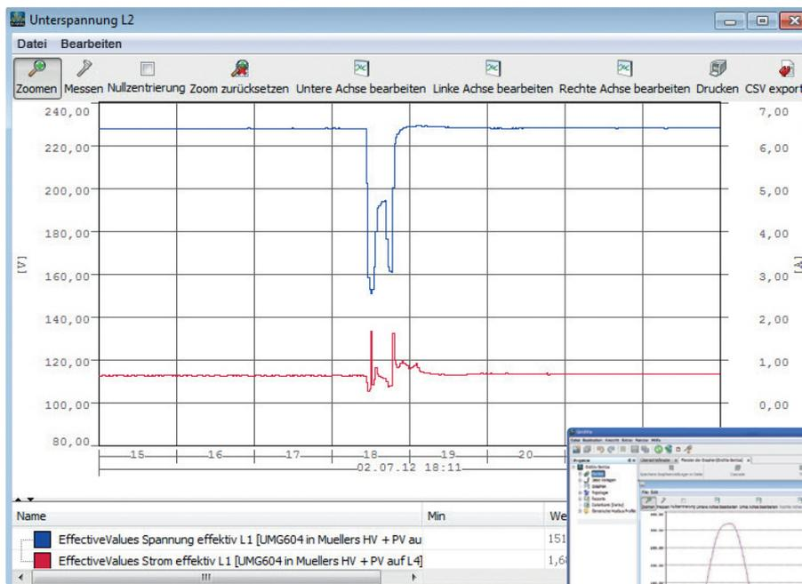
Der Ereignisbrowser gibt einen schnellen Überblick über Spannungseinbrüche mit Datums- und Zeitstempel, Länge und Tiefe des Spannungseinbruchs
