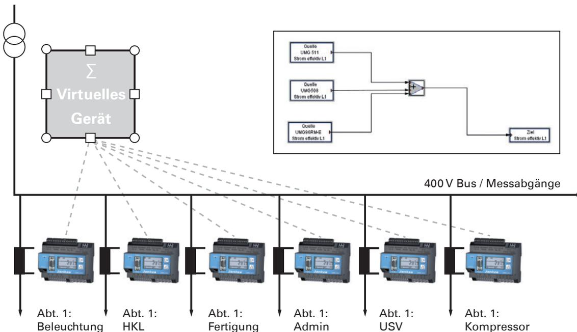
Das virtuelle Messgerät berechnet den Gesamtverbrauch in der Zuleitung
