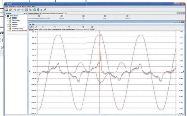
Detailanalyse eines kritischen Spannungseinbruchs
