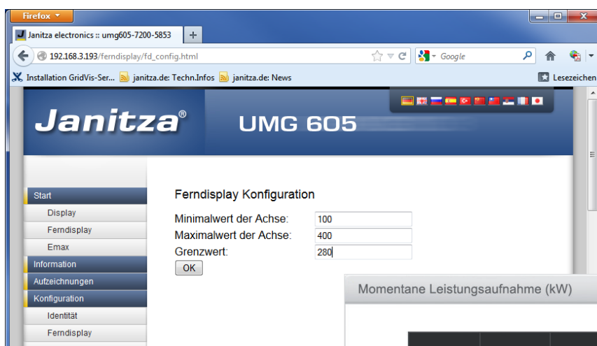
Abb.: Konfiguration Ferndisplay mit Achsen-Skalierung von 100 (Minimalwert) bis 400 (Maximalwert) kW und gesetztem Grenzwert (280 kW)
